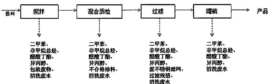
水性涂料生产工艺流程及产污节点图
