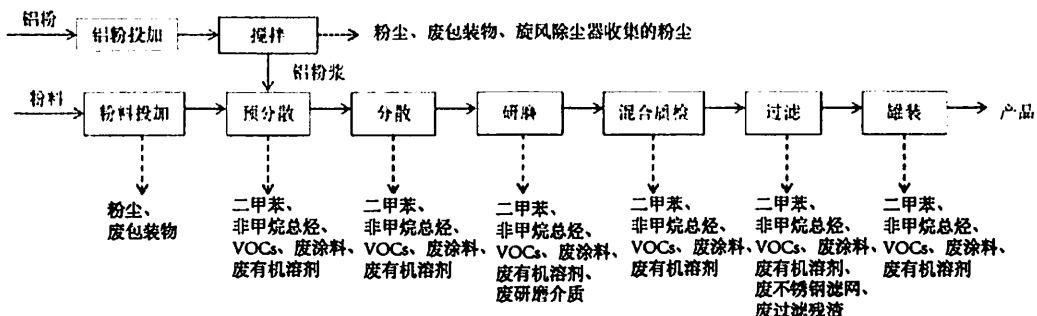
高固体分涂料生产工艺流程及产污节点图
